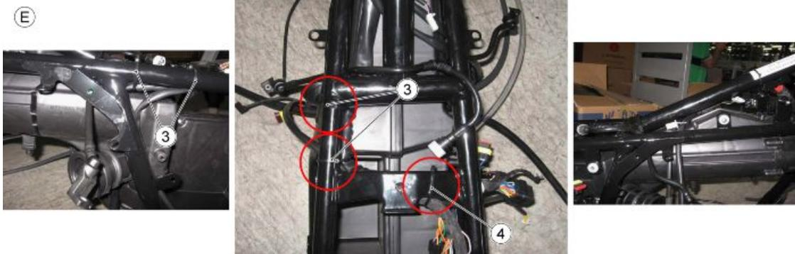
**TABLE F - POSITIONNEMENT DE L'INSTALLATION DE L'INTERRUPTEUR DE PHASE**
