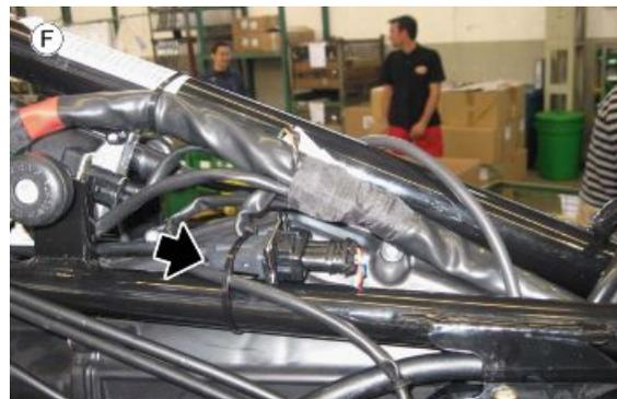
**TABLE G - POSITIONNEMENT DE L'INSTALLATION DE L'INTERRUPTEUR DE PHASE**
